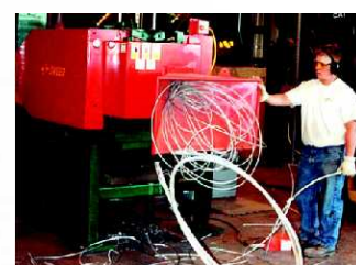
MODEL 5503 a 5703 vhodný pro nejnáročnější lineární recyklace zejména komunikačních kabelů
