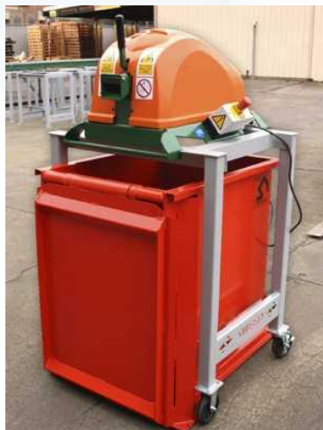
MODEL 300 pro plastové a ocelové pásky do šířky 19mm
