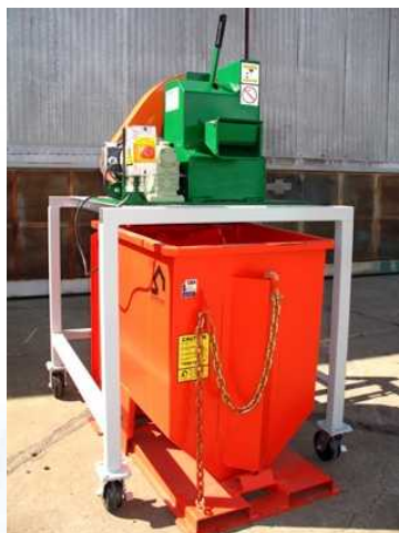
MODEL 510 XHD drtič šrotu, lišt, lemování a ocelové pásky do 32 mm
