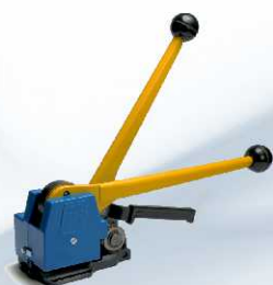
US 10 - univerzální páskovač ocelové pásky šířky 13-20 mm, spoj průřezem, síla utahení 3000N, hmotnost 4.25 kg
