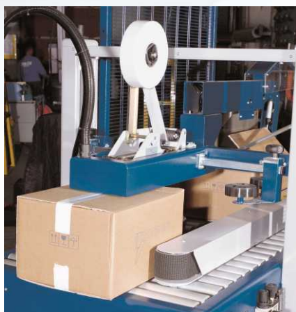
Detail horní lepicí hlavy - mechanické nastavení velikosti kartonu kolečkem
