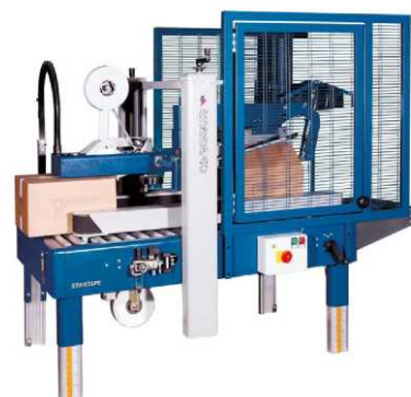
StarTape CF Pohon bočními pásky, ruční nastavení formátu, automatické uzavření horních klop
