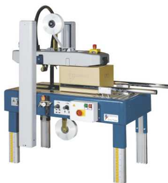
StarTape TBDA Pohon horními a spodními pásky, automatické nastavení formátu.
