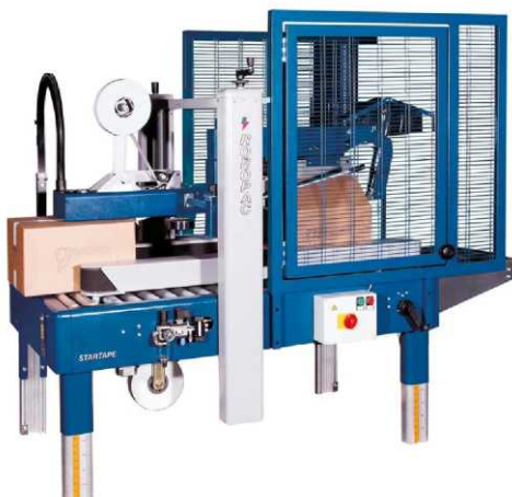
Pohon kartonové krabice bočními pásy - mechanické nastavení velikosti kartonu klikou
