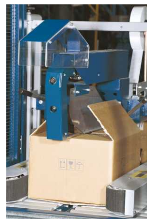
Pneumatické uzavření horních klop kartonu
