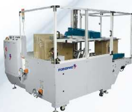
SUPERBOX - automatická skládačka s lepením dna
