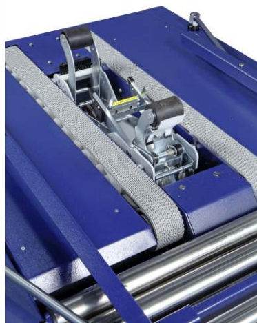
Posun produktu zajišťují horní a spodní poháněné pásy
