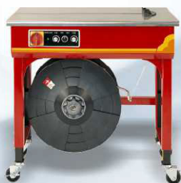
TP-502 s technologií 24 V, pro úzkou pásku šířky 5-13mm, síla utažení 8-45 kg
